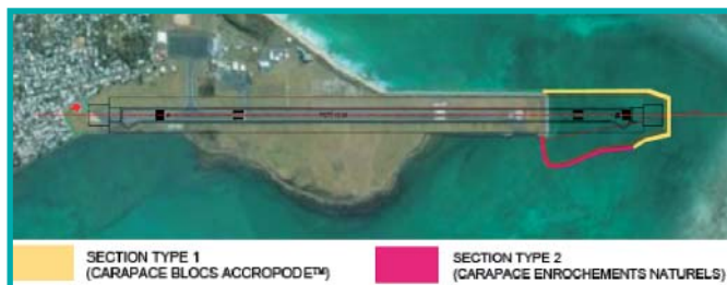
Scénario 1 Etape 1 – Plan des protections maritimes (ADPi-SOGREAH, 2010)
