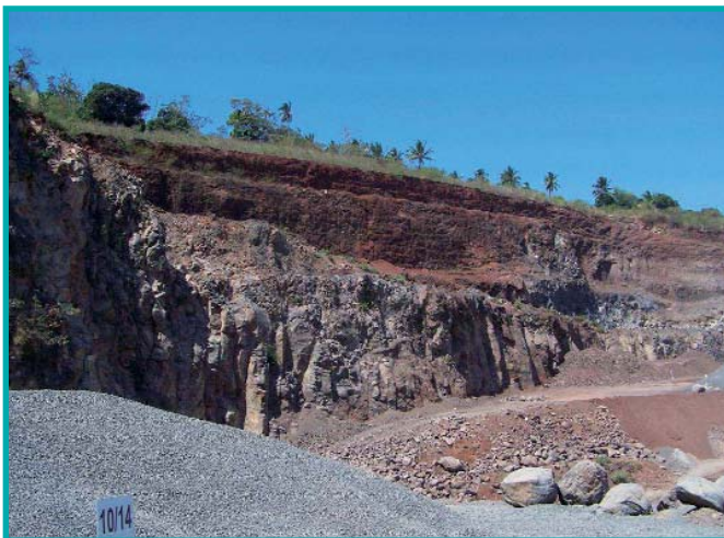
Carrière de Pamandzi (BRGM, 2009) (Front de taille : superposition basalte gris et matériaux scoriacés altérés rouges)
